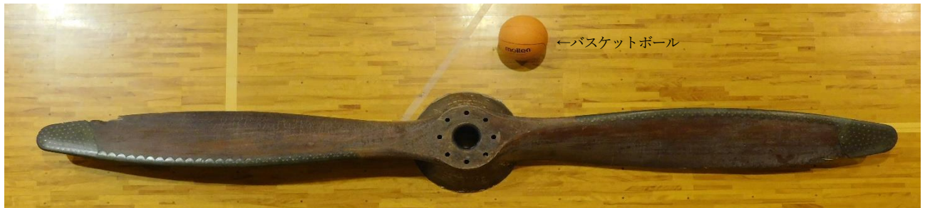
旧日本海軍の九四式水上偵察機に装着されていた木製のプロペラ（長さ3.9m、重さ40kg）前縁を真ちゅうで覆い、強度を高めている。
